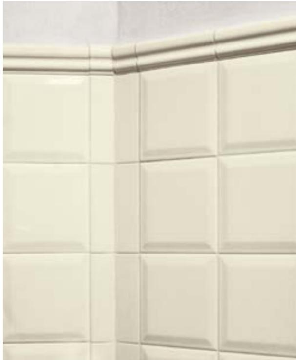
In presenza di un angolo interno maggiore o minore di 90°, utilizzare la piastrella piana per i tagli e sagomare la cornice e il battiscopa con l'angolatura necessaria. Non utilizzare lo sguscio interno e l'angolo interno di cornice e battiscopa.
